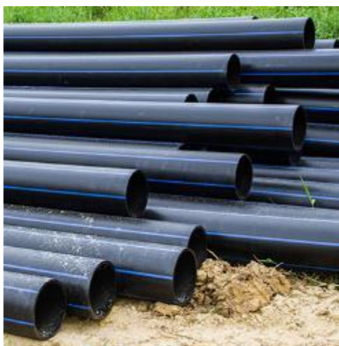
Photographie 4 : Conduites en PEHD destinées à l'alimentation en eau potable
